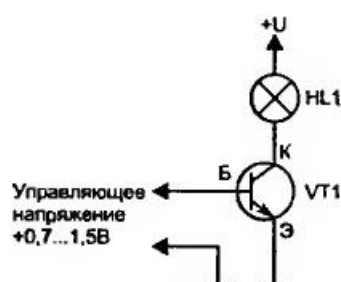
Рис. 1.11. Схема включения биполярного транзистора с общим эмиттером
