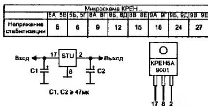
Рис. 2.6. Стабилизатор напряжения на микросхемах КРЕН5, КРЕН8 и КРЕН9
