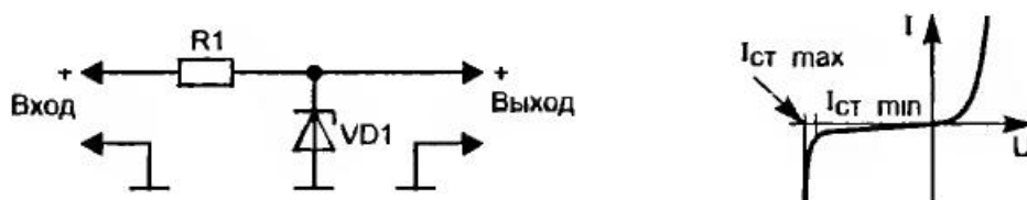
Рис. 1.8 Схема включения стабилизатора
