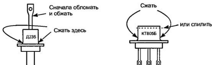
Рис. 3.24. Методы вскрытия металлических корпусов полупроводников
