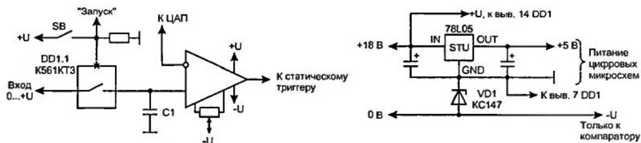
Рис. 2.18. Устройство выборки-хранения и источник питания для него
