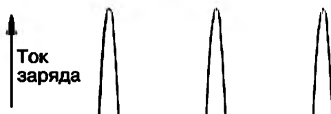
Рис. 6.9 Форма импульсов тока пульсаций
