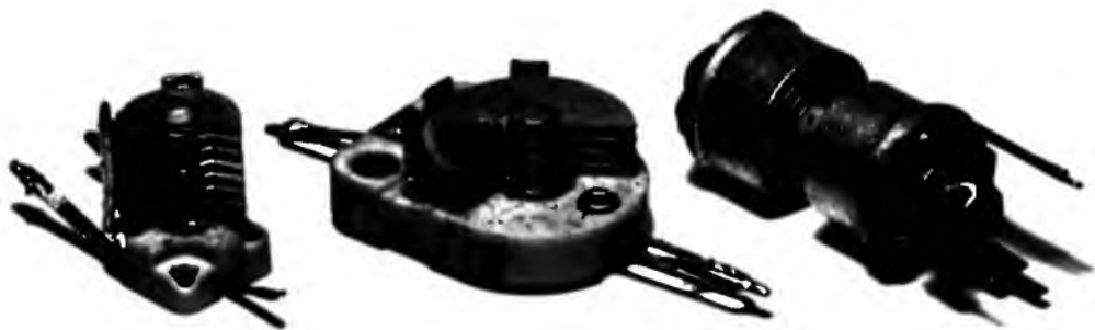
Рис. 5.5 Некоторые типы переменных конденсаторов с воздушным зазором. У показанного справа подстроечного конденсатора ротор несколько выдвинут из корпуса, чтобы были видны пластины конденсатора
