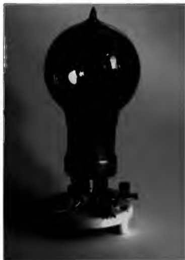
Рис. 2.1 Лампа R-типа, видны следы потемнения на колбе. (Вытравленная надпись утверждает, что эта лампа является «Типом, одобренным главным почтмейстером Би-би-си»)
