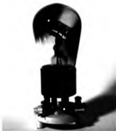
Рис. 2.40 Лампа P215 с катодом прямого накала, имеющего оксидное покрытие
