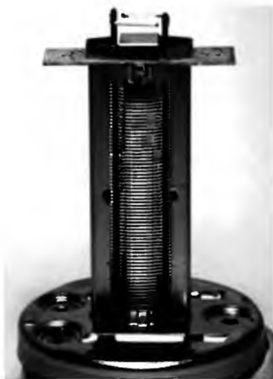
Рис. 2.47 Пластины, формирующие поток электронов, и конструкция катод-сетка СВЧ сдвоенного лучевого тетрода типа QQV07-50
